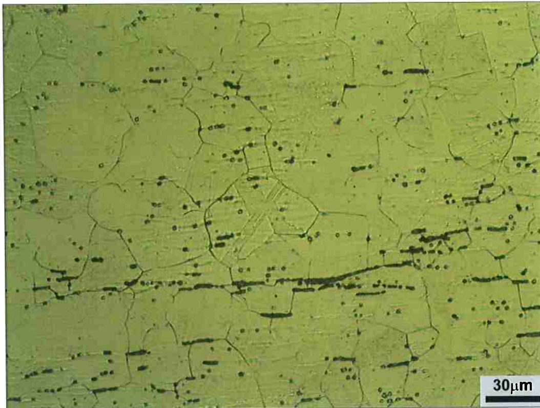
Figura 5.4 - Imagem de microscopia ótica do aço 304L TCR. Nota-se que a microestrutura é composta por matriz de grãos recristalizados de austenita, com presença de maclas e, ainda, valas que correspondem à precipitação de ferrita (delta) a qual foi dissolvida pelo ataque metalográfico. Ataque eletrolítico: ácido oxálico 10%. Aumento: 500x.
