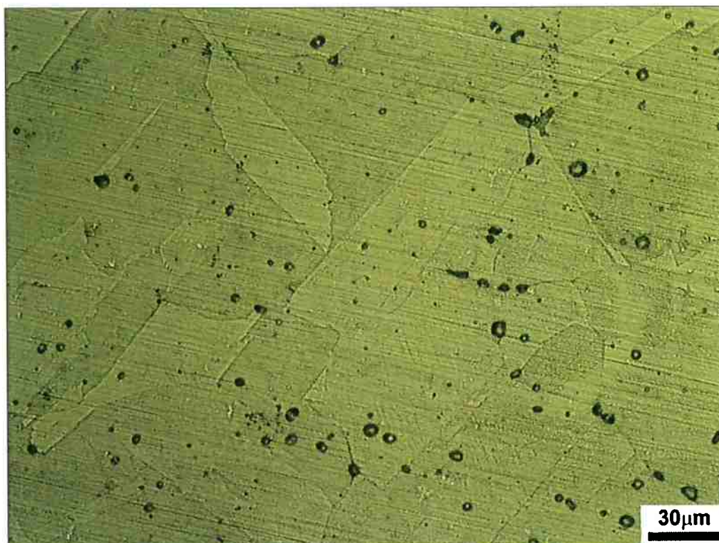
Figura 5.3 - Imagem de microscopia ótica do aço 298 solubilizado a 1100°C. Nota-se que a microestrutura é composta por matriz de grãos recristalizados de austenita, com presença de maclas. Observa-se que houve crescimento de grão, comparativamente à condição TCR e que praticamente não se observa a presença de ferrita (delta). Ataque eletrolítico: ácido oxálico 10%. Aumento: 500x.
