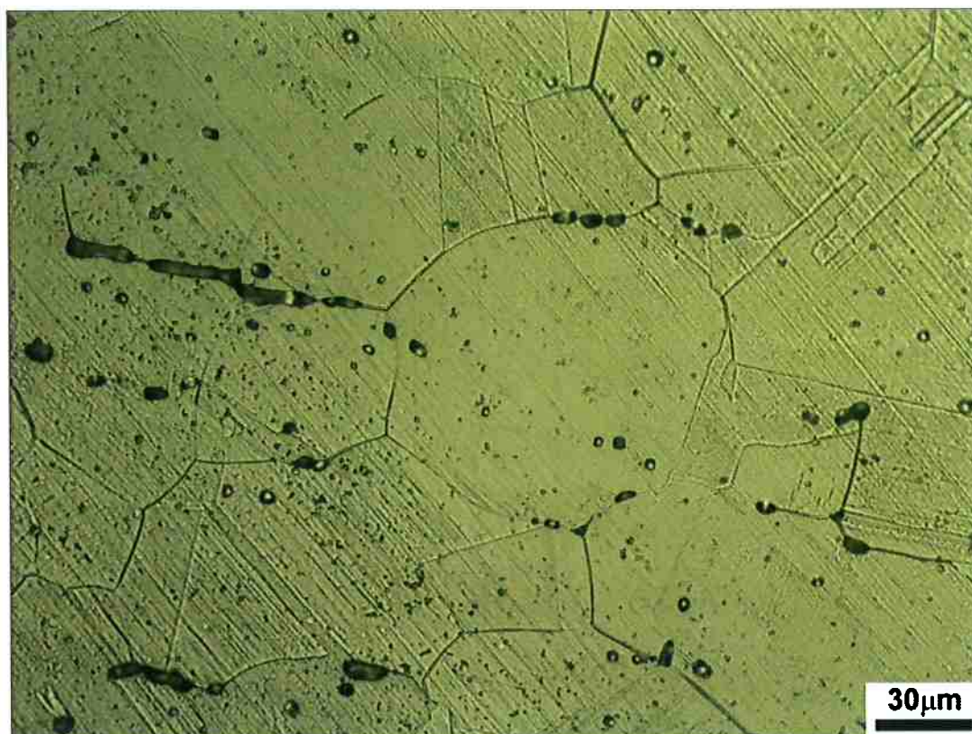
Figura 5.5 - Imagem de microscopia ótica do aço 304L solubilizado a 1100°C. Nota-se que a microestrutura é composta por matriz de grãos recristalizados de austenita, com presença de maclas. Observa-se que houve crescimento de grão, comparativamente à condição TCR. Observa-se também a presença de ferrita (delta), mas em menor quantidade do que a da condição TCR (Figura 5.4). Ataque eletrolítico: ácido oxálico 10%. Aumento: 500x.
