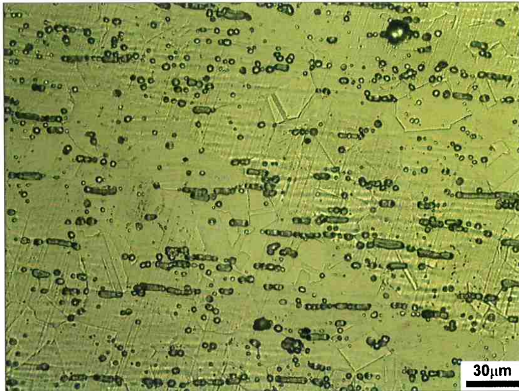
Figura 5.2 - Imagem de microscopia ótica do aço 298 TCR. Nota-se que a microestrutura é composta por matriz de grãos recristalizados de austenita, com presença de maclas e, ainda, valas que correspondem à precipitação de ferrita (delta) a qual foi dissolvida pelo ataque metalográfico. Ataque eletrolítico: ácido oxálico 10%. Aumento: 500x.
